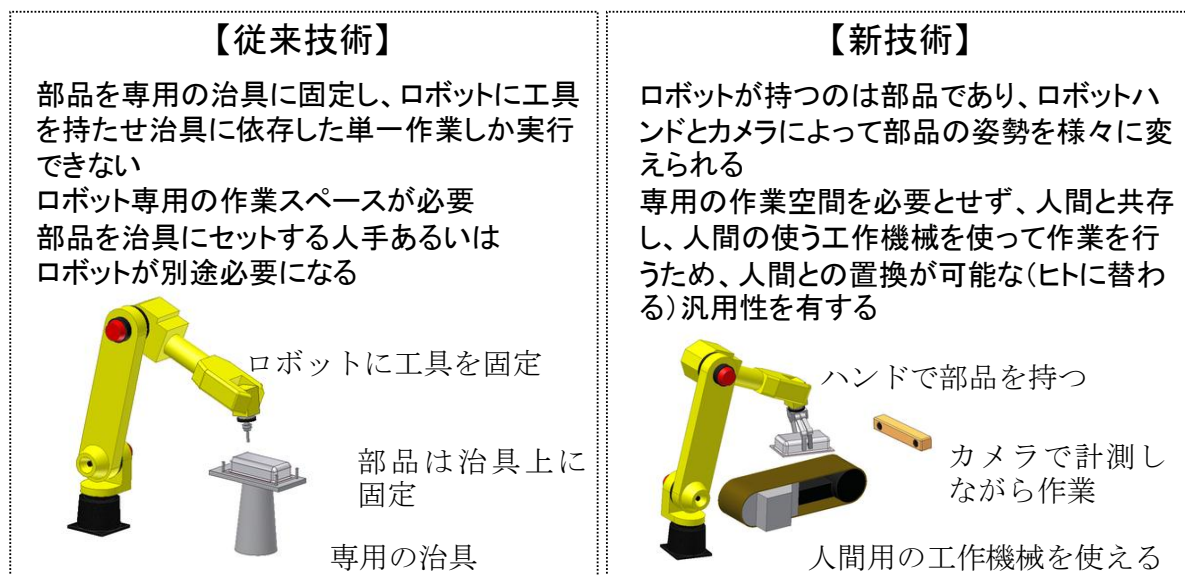
図 1-1 従来技術と新技術の比較模式図
