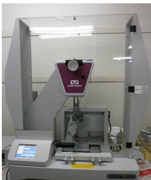
図4. 計装化衝撃試験機「CEAST 9050」(左)とハンマー式(右)
